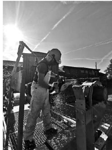
Arbeiten sehr gering zu halten. In den Simulator können Bäumen eingelegt werden und anschließend hydraulisch in verschiedene Richtungen gedrückt werden, was so den Baum unter Spannung setzt, wie es auch bei einem umgefallenen Baum der Fall sein kann. Beim Schneiden eines solchen Baumes ist es dann äußerst wichtig, zu erkennen welche Bereiche, wie unter Spannung steht, da sonst Fehler beim Arbeiten gemacht werden könnten, was im schlimmsten Fall durchaus in einer
